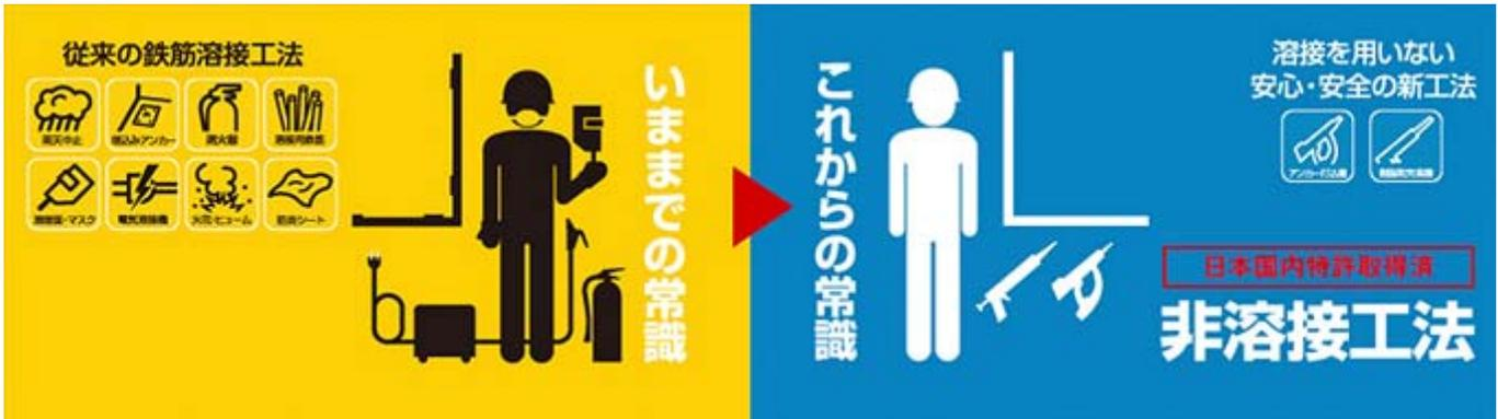
非溶接工法とは、従来の溶接工法に替わる新しいサッシの施工方法です。RC造の建物には樹脂材の硬化によってサッシを固定する「高強度樹脂接合」、S造（ALCパネル納まり）の建物には「アジャストアンカー接合」を展開しています。
