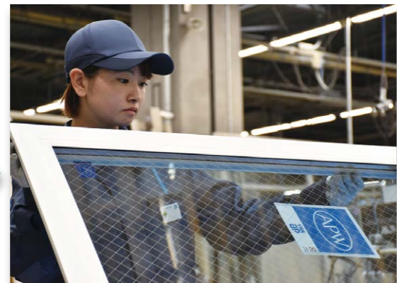
加工・組立・包装 「APW」樹脂窓シリーズは管理された自社工場、ガラスや部品を含めた窓として組み立てまで行うことで、高い性能を担保しています。
