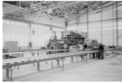
1959年に設置したアルミ押出機
