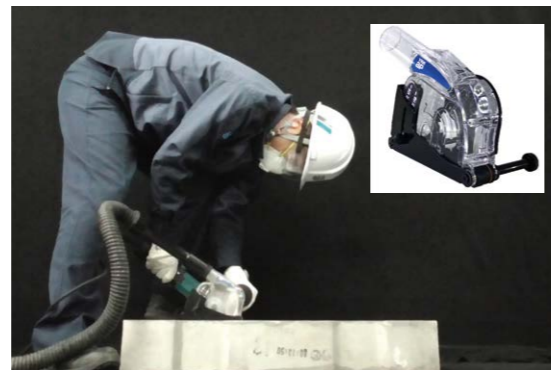
「ダイヤモンドカッター用 集塵カバー」(右上)を活用した施工風景
